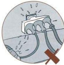
Los accidentes se producen cuando el cuerpo humano entra en contacto con dos elementos a distinta tensión. En este momento, el cuerpo se vuelve parte de un circuito y pasa la corriente a través de él.
